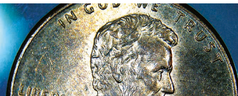
Episcopía en posición 3: los dos LED inferiores proyectan una iluminación plana sobre el objeto de estructura fina, resaltando así el contraste.
